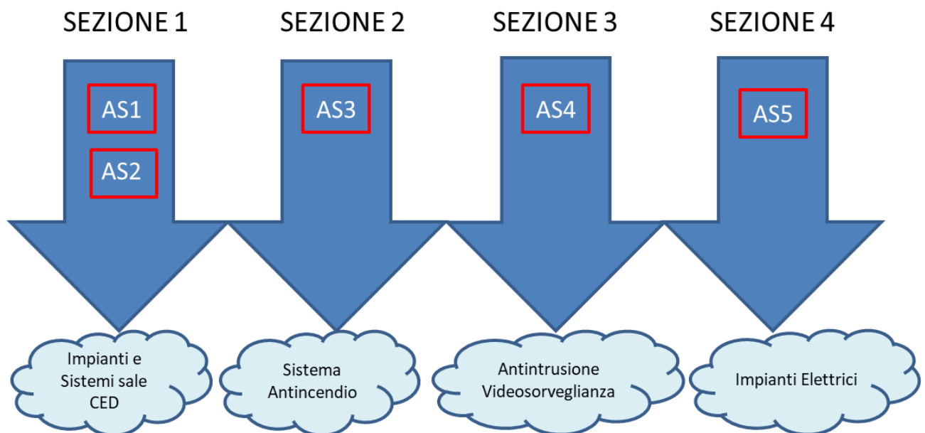
Figura 3 – Suddivisione degli Automation Server nelle relative sezioni di monitoraggio BMS CEN
