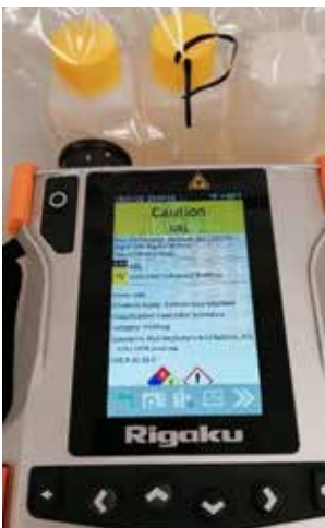
GBL sequestrato in flaconi analizzato mediante RAMAN
