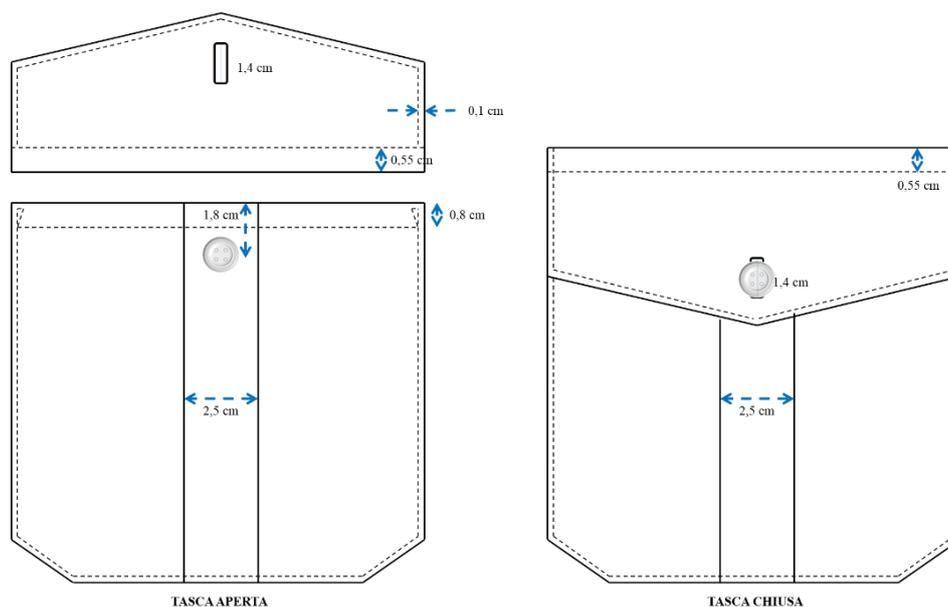
**Figura 4:** disegno della geometria della tasca a titolo esemplificativo non in scala.
