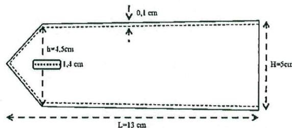
Figura 5: disegno della geometria della contropallina a titolo esemplificativo e non in scala, per la taglia 38.
